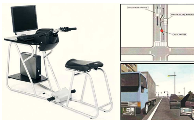
Figura 1 A la izquierda, la Honda Riding Trainer que es un simulador estático de bajo coste usado principalmente para mejorar la conducta de riesgo y las habilidades de percepción. A la derecha, un ejemplo de situación de tráfico de riesgo presentada a los participantes. Arriba, representación esquemática de una situación de peligro siendo el punto rojo el vehículo participante. Abajo, la misma escena pero desde la perspectiva del participante.
