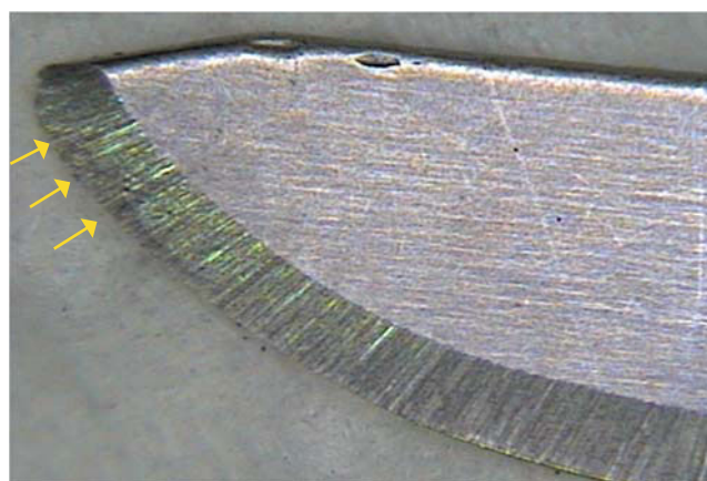
Figura 4. Hoja de bisturí Elite® D3 después de ser utilizada. En el borde se nota la opacidad del filo, lo que se interpreta como deformación física de la hoja.
