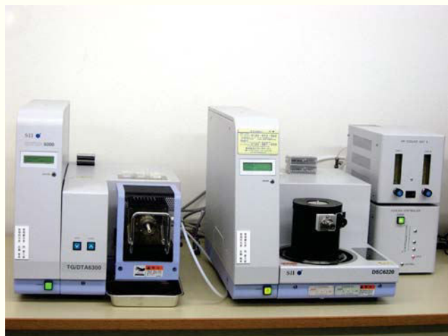
Figura 7. Aparato utilizado para la prueba de escaneo por barrido diferencial (Seiko SII-DSC6220).
