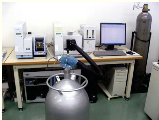
Figura 8. Sistema de enfriamiento con base en nitrógeno utilizado para la prueba.
