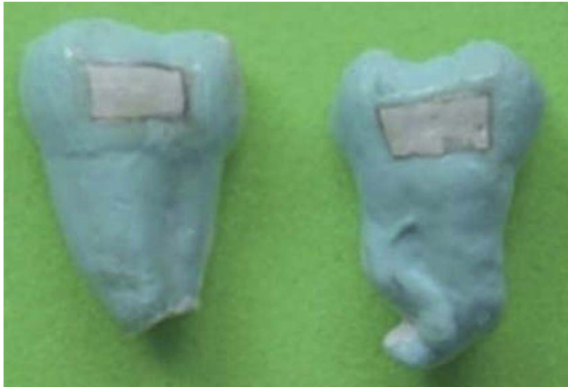
Figura 2. Preparación de las muestras. Se elaboró una ventana de trabajo de 3.0 x 6.0 mm delimitada por barniz ácido resistente.
