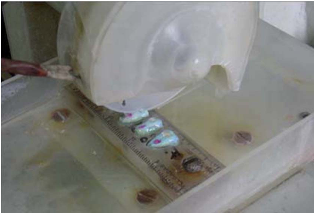
Figura 3. Preparación de especímenes en una recortadora de disco de diamante.
