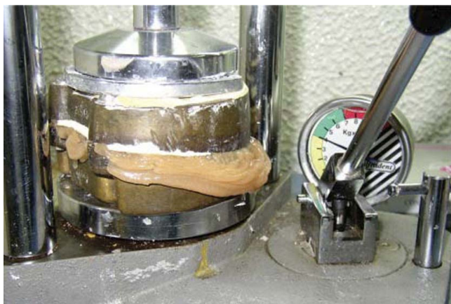
Figura 28. Prensado de la mufla con la prensa hidráulica.
