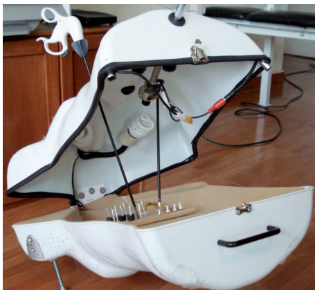
Imagen 2. Simulador inanimado mecánico con seis puertos de entrada para los instrumentos laparoscópicos, con una separación de 5 a 7 cm entre cada uno de ellos.
