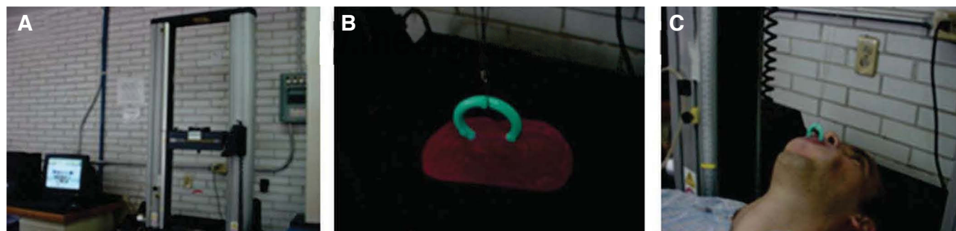
Figura 4. Prueba de tensión in vivo . A) Máquina universal de pruebas. B) Pantalla oral. C) Prueba de tensión.
