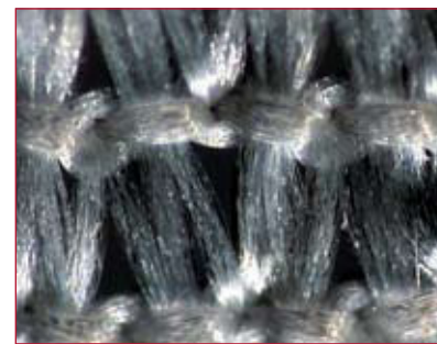
FIGURA 12: Malla Multifilamento. Malla IVS, que corresponde a la clasificación Tipo 3. Es multifilamento y microporo.
