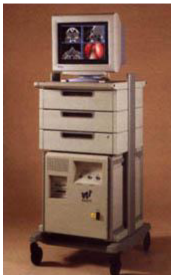
Figura 7. Navegador Instatrak 3000, que utiliza un sistema de seguimiento electromagnético de los instrumentos. Es una workstation Sun con sistema operativo Unix, implementada con el hardware de navegación. Recibe las imágenes de TAC o RM a través de la red Ethernet.
