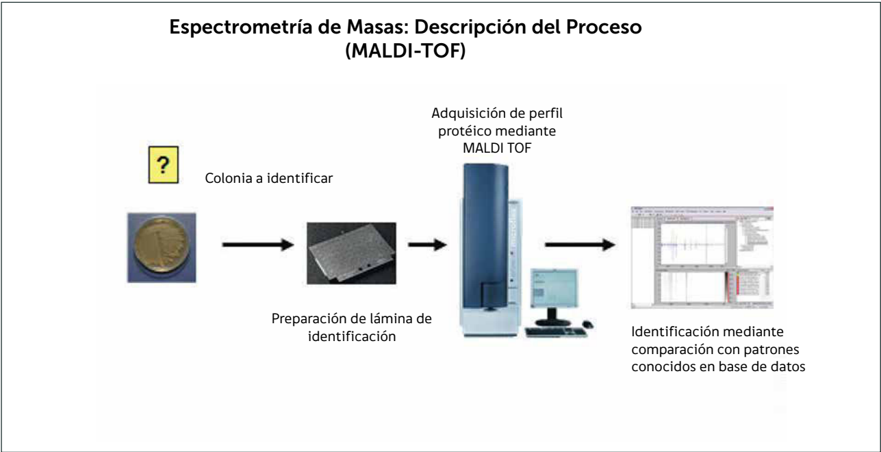
FIGURA 1. METODOLOGÍA DE ESPECTOMETRÍA DE MASAS (MALDI-TOF)
