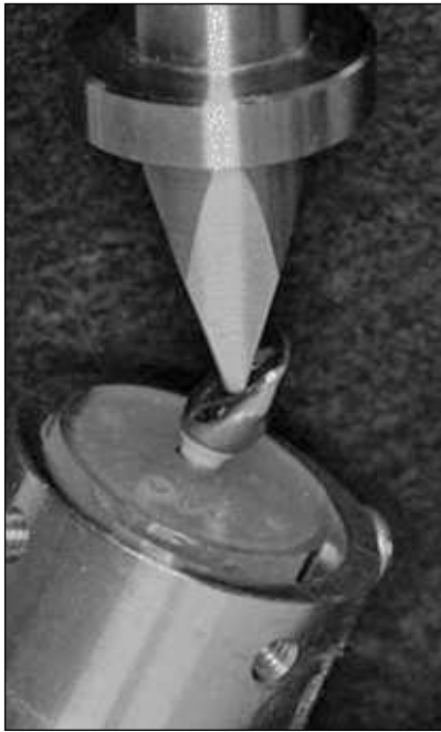
Figura 1 Colocación y orientación de la pieza en un ángulo de 30 grados con el eje de carga durante la prueba de fatiga acelerada.
