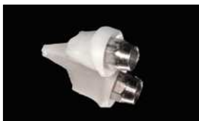
Figura 4a Fotografía digital de la muestra 2 indicando la fractura de las paredes axiales debido a un exceso de reducción.
