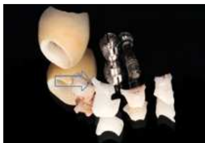
Figura 1a Fotografía digital de la muestra 1 indicando la localización de la fisura crítica en uno de los fragmentos.
