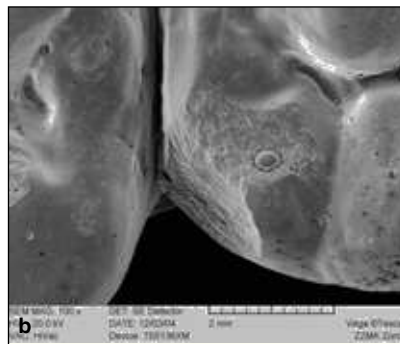
Figuras 3a y 3b PDF mandibular de 3 unidades de cerámica a base de circonia con un fragmento en el puente (USPHS: B). Se aprecia una estrecha relación entre el área rugosa en el extremo de la cúspide distolingual y el fragmento sobre el análisis SEM de la réplica.
