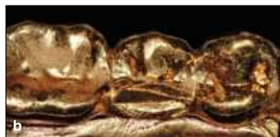
Figuras 5a a 5c Fractura clínicamente inaceptable del recubrimiento de cerámica veneer sobre una PDF superior de cerámica a base de circonia de 5 unidades. El análisis fractográfico reveló que las fisuras se habían iniciado en los conectores mesial y distal y se propagaron al centro de la cúspide palatina.
