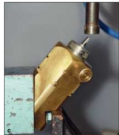
Figuras 2a - 2c (a) Unión implante-pilar para el sistema con CI; (b) unión implante-pilar para el sistema con HI; (c) montaje de las muestras colocadas en la máquina de pruebas para realizar las pruebas con cargas compresivas oblicuas (a 45 grados).
