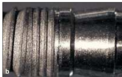
Figuras 2a - 2c (a) Unión implante-pilar para el sistema con CI; (b) unión implante-pilar para el sistema con HI; (c) montaje de las muestras colocadas en la máquina de pruebas para realizar las pruebas con cargas compresivas oblicuas (a 45 grados).
