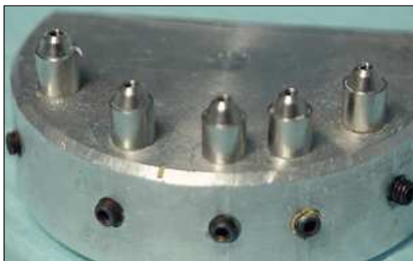
Figura 1 Modelo metálico realizado en aleación de aluminio con las réplicas de los pilares fijadas
