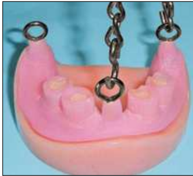
Figura 3 Dos cadenas unidas diagonalmente para comprobar las fuerzas de desalojo oblicuo
