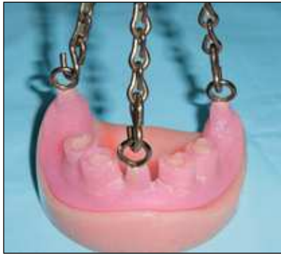
Figura 2 Prueba de retención: posición de las cadenas para el estiramiento vertical de 3 puntos
