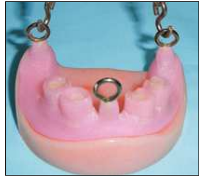
Figura 4 Dos cadenas unidas distalmente a la zona molar para comprobar las fuerzas de desalojo rotacional
