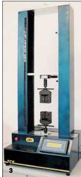
Fig. 3 (izquierda) Máquina de prueba para las pruebas de tracción y torsión.
