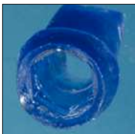
Fig. 4 Pilar de plástico separado del componente de titanio.
