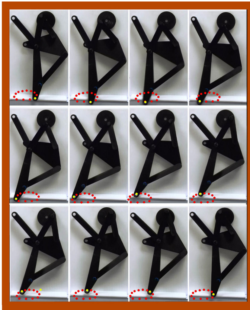
Figura 9. Fotogramas del prototipo experimental del mecanismo de marcha realizando un movimiento completo en la manivela.
