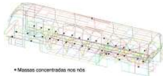
Figura 4. Massas concentradas aplicadas no modelo.
