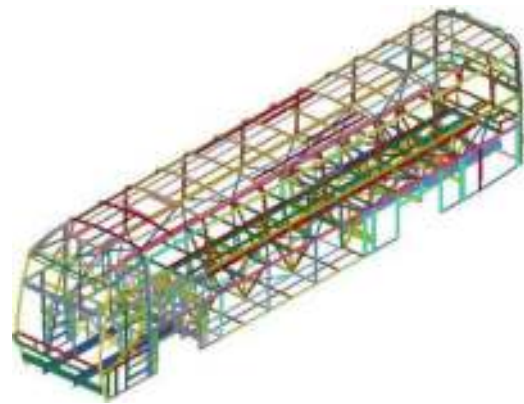
Figura 3. Modelo numérico do ônibus.
