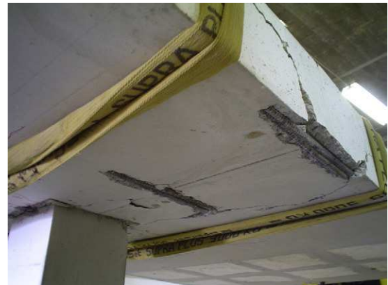
Figura 10. Fallo de adherencia y rotura a torsión en espécimen.
