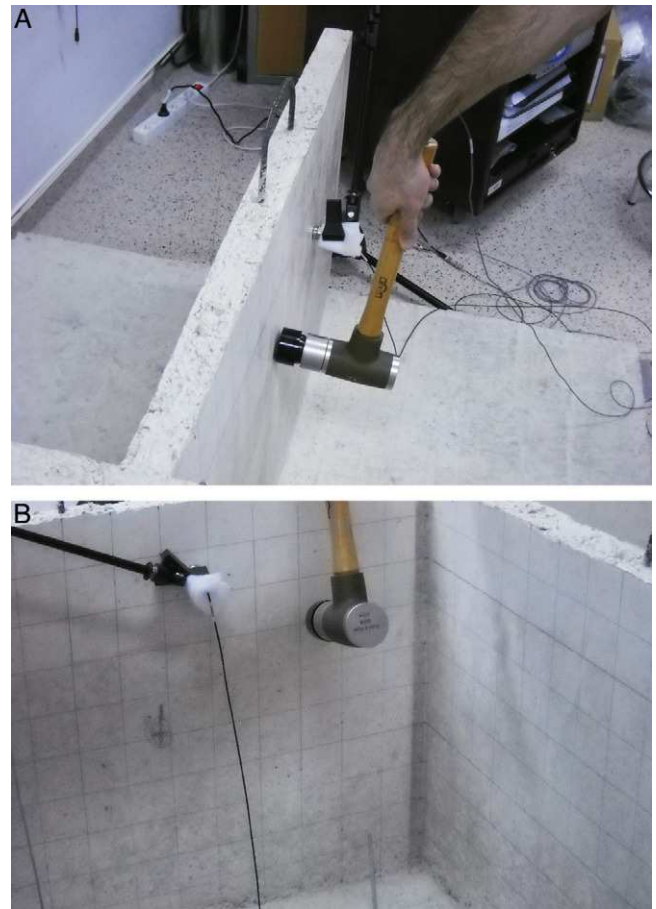
Figura 1. Detalle de la medición del tiempo de reverberación estructural en la maqueta de hormigón.
