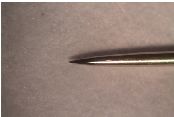
Figura 2 Imagen de la aguja para acupuntura de la marca DBC, de 0,25 mm de diámetro. Fotografía 40×.
