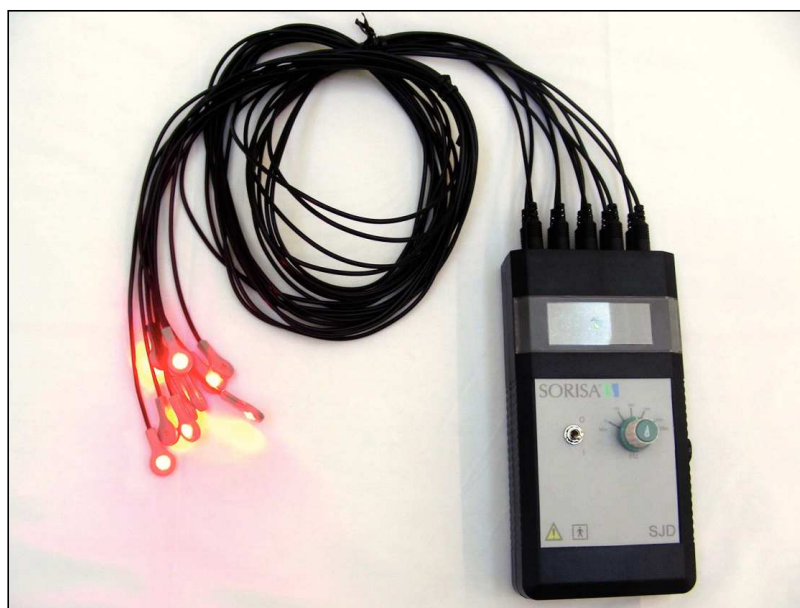
Fig. 1: Equipo de LED diseñado por SORISA para el tratamiento de puntos de acupuntura. Consiste en 10 salidas con LED emisores a 617 nm, que se adhieren sobre el punto a tratar.
