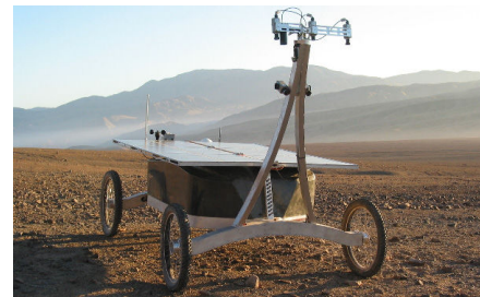
Figura 13: Imagen del proyecto ASTEP, y el uso de uno de sus prototipos de UGV para la recogida y análisis de sustancias para la búsqueda de vida, mediante el uso de un robot Zoë en el desierto de Atacama en Chile. Crédito: Carnegie Mellon University/NASA.
