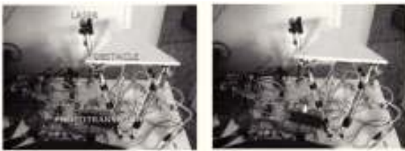
Figura 11: A la izquierda, el prototipo está listo para realizar la medida. En esta configuración, la esquina de la plataforma móvil evita que el haz láser impacte sobre el fototransistor. A la derecha, la plataforma móvil comienza a moverse y el fototransistor recibe la luz láser.
