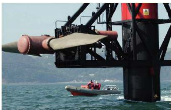
Figura 9: Turbina MCT SeaFlow de 300 kW primera turbina de corriente marina en alta mar que se instaló frente a Lynmouth, Devon, en mayo de 2003 en operación de mantenimiento. (Comission, E. Ocean energy conversion in Europe, 2006)
