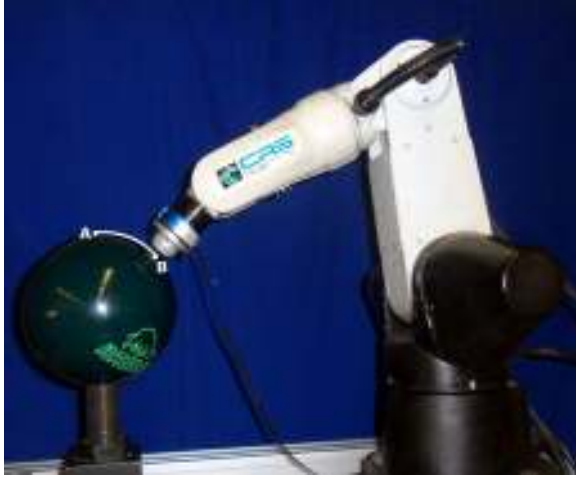
Figura 1: Manipulador A465 de CRS Robotics con una superficie esférica.
