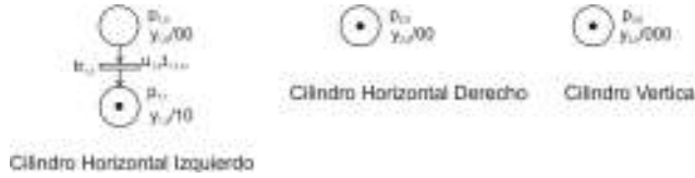
Figura 6: Proceso de modelado del brazo robótico a partir del lenguaje: paso 1
