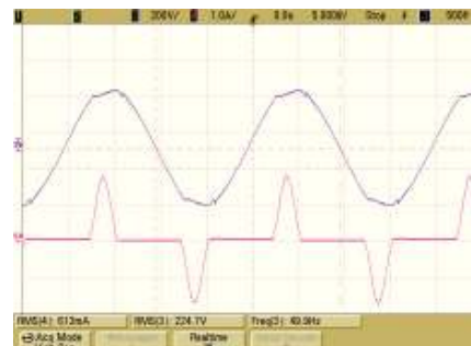
Figura 20. Voltaje de salida del inversor con carga no lineal, PI + CRes (superior, 200V/div) y corriente de salida del inversor con carga no lineal, PI + CRes (inferior, 500mA/div). Escala de tiempo=5ms/div. THD_v = 4.8\% .
