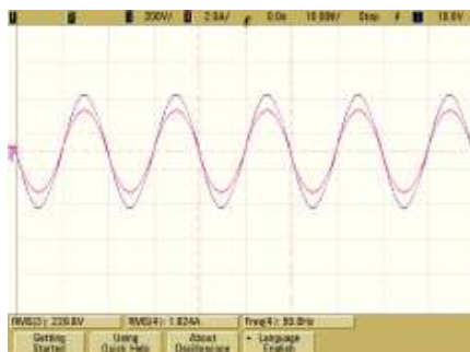
Figura 18. Voltaje de salida del inversor con carga resistiva, controlador PI-P + CRes (púrpura, 200V/div) y corriente de salida del inversor para una carga resistiva, controlador PI-P + CRes (rojo, 2A/div). Escala de tiempo=5ms/div. THD_v = 0.8\% .
