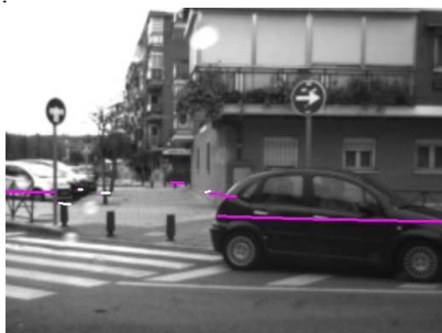
Figura 5. Reconstrucción de polilíneas superpuestas en la imagen de la cámara.
