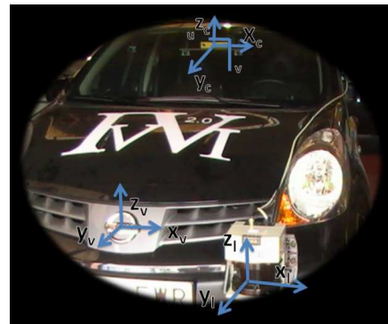
Figura 8. Diferentes sistemas de coordenadas en el vehículo. (x_c, y_c, z_c) es el sistema de coordenadas de la cámara, (x_i, y_i, z_i) es el sistema de coordenadas del láser, y (x_v, y_v, z_v) es el sistema de coordenadas. Las coordenadas (u, v) son las coordenadas de la imagen.
