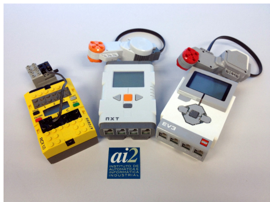
Figura 1: Unidades de control RCX, NXT y EV3 y sus respectivos actuadores eléctricos de Lego Mindstorms desarrolladas.
