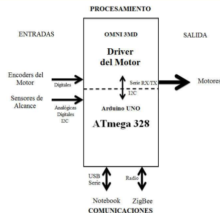
Figura 4: Arquitectura de control de la plataforma robótica.
