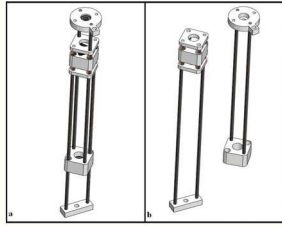
Figura 10: a) Modelo mecánico del actuador para la rodilla, b) Modelo mecánico del actuador para la rodilla desacoplado en las dos partes principales que lo conforman.
