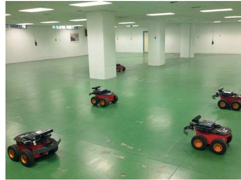
Figura 2: Fotografía del banco de pruebas instalado en una sala de 500 m² en los sótanos del edificio principal de la Escuela Técnica Superior de Ingeniería de la Universidad de Sevilla. Pueden observarse 5 robots Pioneer 3-AT y los nodos de la red WSN colgando del techo.
