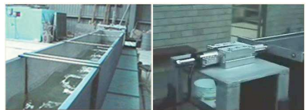
Figura 2: Vista del canal y motor lineal con el batidor de paleta.
