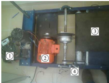
Figura 9: Plataforma experimental empleada para el control de velocidad del motor de CA: 1.- Driver eléctrico de CA, 2.- Motor de inducción trifásico, 3.- Caminadora y 4.- Generador taquimétrico.
