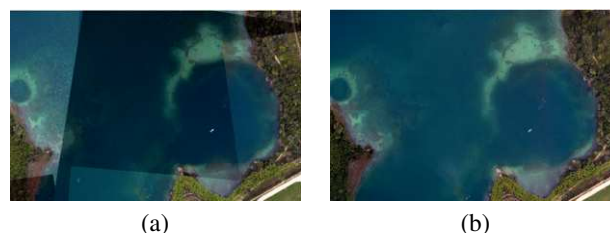
Figura 4: Detalle de una región central del mosaico del lago de Banyoles antes (a) y después (b) de la aplicación de la técnica de fusión. En el área del detalle contribuyen un total de seis imágenes, con evidentes diferencias de exposición. La imagen resultante es totalmente continua, sin visibilidad de costuras, y la exposición es constante en todo el área.
