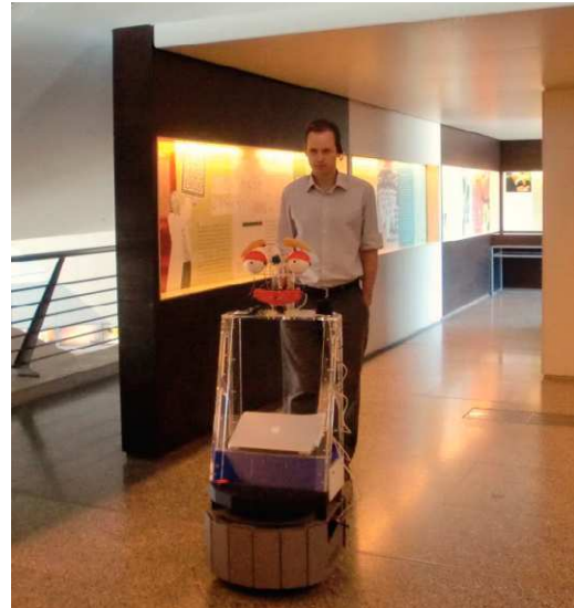
Figura 16. Doris guía a una persona hacia el punto de interés que se le ha solicitado por medio de un comando de voz. Para ello Doris planifica sobre el mapa de navegabilidad generado en la fase de configuración inicial.
