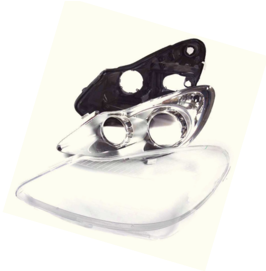
Figura 1: Ejemplo de piezas a ensamblar para la construcción de un faro de automóvil (de atrás hacia delante): carcasa, embellecedor y cristal. Las tres piezas son fabricadas de distintos materiales plásticos.
