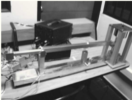
Figura 2: Maqueta del sistema bola viga con levitación magnética.
