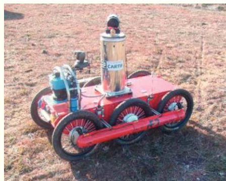
Figura 1: Robot Todoterreno con el sistema de medición tridimensional embarcado.
