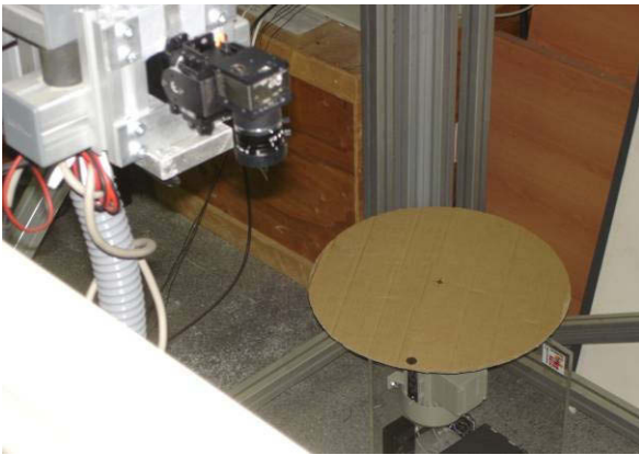
Figura 18. Disco giratorio y cámara en el efector del robot.
