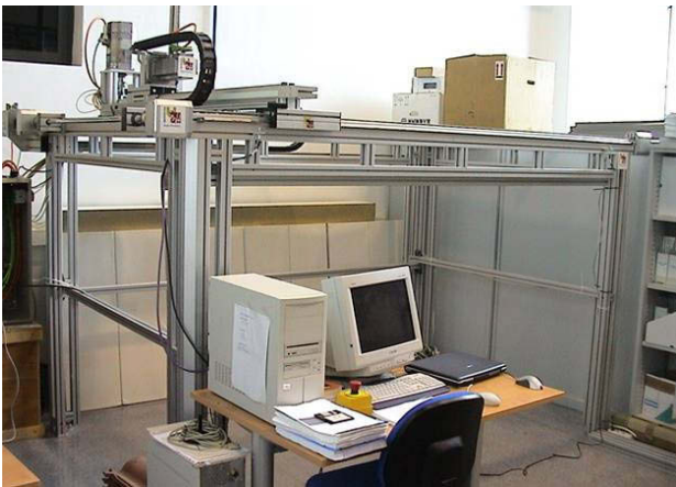
Figura 19. Robot cartesiano de 3-GDLs desarrollado en la UMH.
