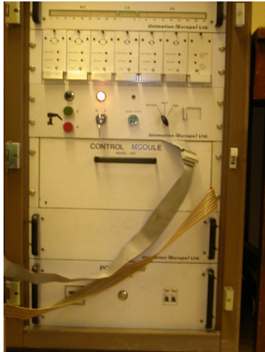
Figura 4: Controlador Mark II del PUMA-560. En el módulo de control se disponen las nuevas tarjetas de interface con el PC a través de la tarjeta de adquisición Q8.
