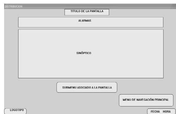
Figura 2. Un ejemplo de distribución de objetos realizado con el programa comercial de supervisión Intouch de Wonderware y en el que se ilustra el indicador de Distribución.
