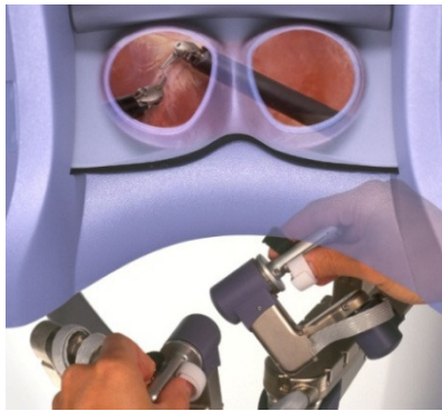
Figura 14. Interfaz maestra: accionamientos y pantalla estereoscópica (©2005 da Vinci, Intuitive Surgical, Inc. )
