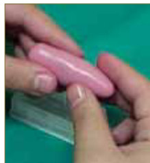
Figura 8: Modelamos la silicona con forma cilíndrica, similar a la de la probeta.
