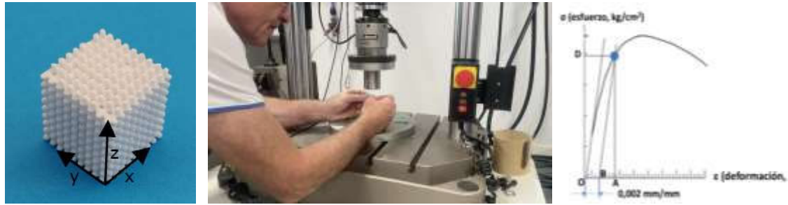
Figura 3. A) Ejes de la muestra. B) Colocación de las matrices. C) Gráfica compresión-deformación.
