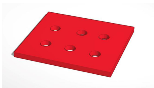
Figura 2. Diseño creado con el software informático Thinkercad® (Autodesk) para fabricar los modelos de PMMA.
