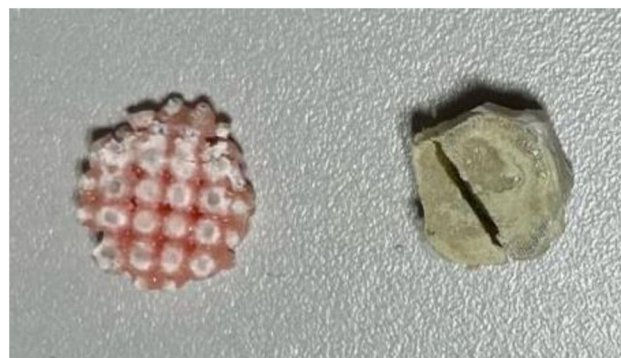
Figura 5. Fotografía de una pieza del modelo A (izquierda, impresión con resina) y modelo B (derecha, cemento) fabricadas con 2 g de amoxicilina-clavulánico.
