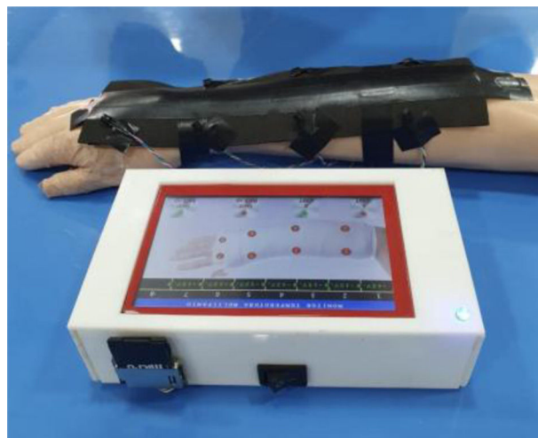
Figura 1 Modelo de simulación de retirada de yeso. El sensor de temperatura está instalado en un simulador de antebrazo pediátrico cubierto por cinta negra.
